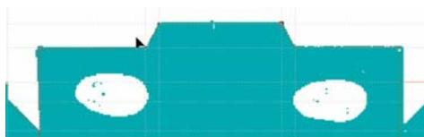
Abbildung 28: Ziehen der Knoten, sodass die Kurve dem Umriss der gescannten Schachtel folgt
