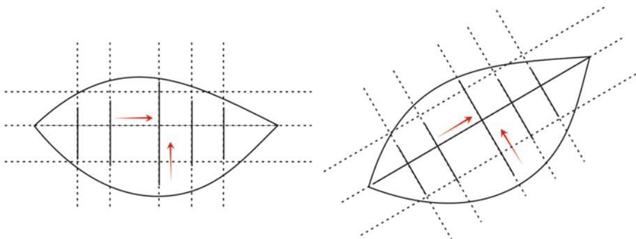
*Figura 2: ruotare l'oggetto in posizione orizzontale o verticale per applicare correttamente il riempimento a reticolo. Dopo aver applicato il riempimento, ruotare di nuovo l'oggetto nella posizione originale*
