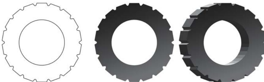
Figura 8: Os trapezoides e o círculo externo são soldados e depois combinados com o círculo menor para criar a exibição plana frontal. Um preenchimento gradiente e uma extrusão são aplicados à forma.
