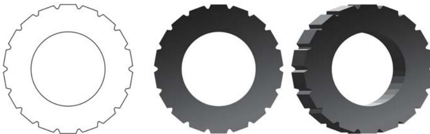
Figure 8 : Les trapèzes et le cercle extérieur sont soudés, puis combinés au cercle intérieur plus petit pour créer la vue de face en plan. Une surface dégradée et du relief sont ensuite appliqués à la forme.
