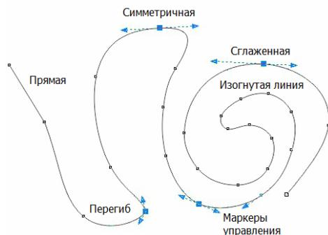
Рис. 6. Различные типы узлов
