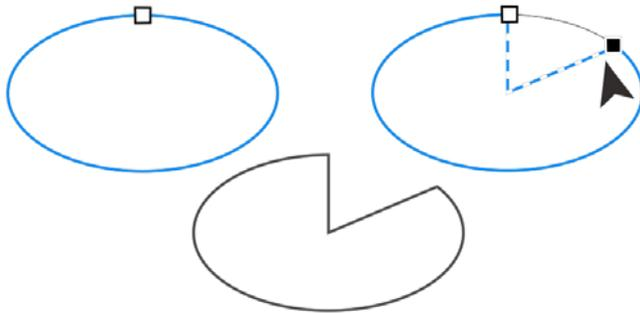
Pour obtenir un arc à partir d'une ellipse, faites glisser le point nodal en maintenant le pointeur à l'extérieur de l'ellipse.
